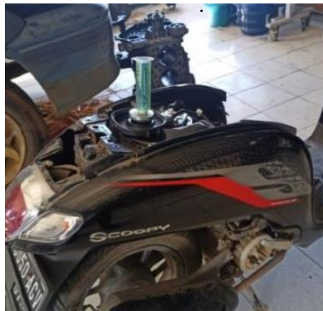
Gambar 7. Pengujian Konsumsi Bahan Bakar
