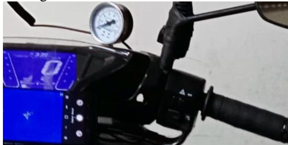
Gambar 3. Pemasangan Pressure Gauge
