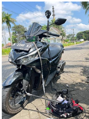
Gambar 5. Pemasangan Camera Thermal
